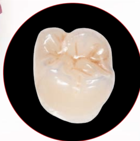
Bemalte Krone nach Verschleißtest
