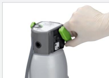
**2.** Drehen Sie den Verriegelungsgriff bis zum Anschlag, drücken Sie den Spülknopf zur Druckentlastung und nehmen Sie den Filterkopf von der verbrauchten Filterkartusche ab.
